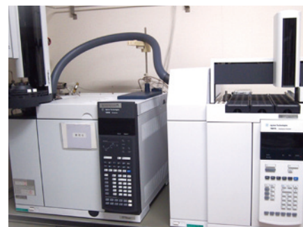
ガスクロマトグラフ（アジレント）
